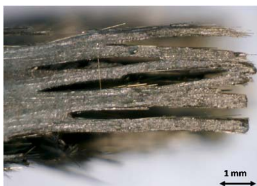
Test sample for 45°, V_f = 36,5, 3,1 \times 10^{-4} s^{-1} .
